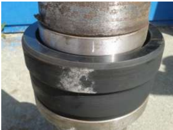
Рисунок 2 – Самоуплотнительная пакерная манжета
